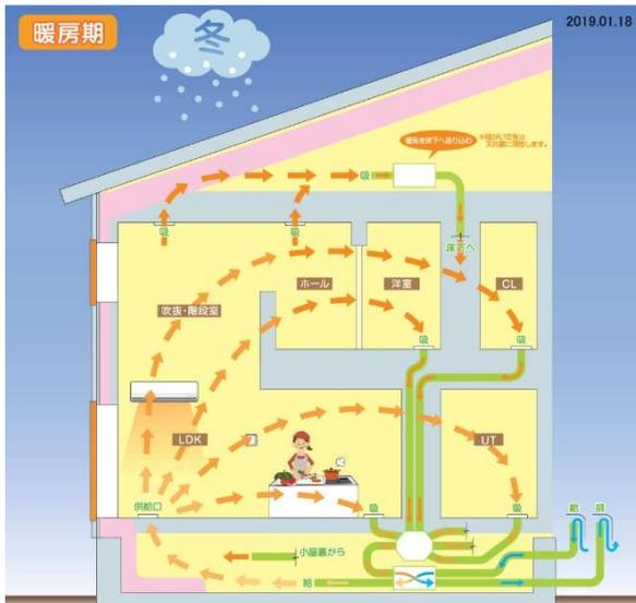
N-Airシステムは換気システムと冷暖房機器の組み合わせにより、1日中新鮮な空気が適切な温度で家中を循環します。
